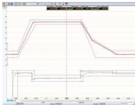
Exemple d'un essai IEC 60068-2-30
