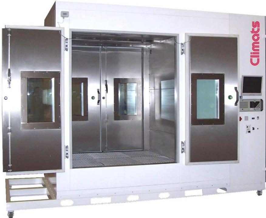
Enceinte climatique monobloc de 2700 dm<sup>3</sup> destinée aux essais sous atmosphère calme, sur une plage de température allant de +20°C à +60°C, avec des vitesses d'air dans le volume comprises entre 0,3 et 0,5 m/s en palier.
