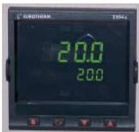
Il permet de réguler la température à l'intérieur du caisson sur une consigne et/ou une pente et d'avoir un affichage et une lecture numérique de cette température.
