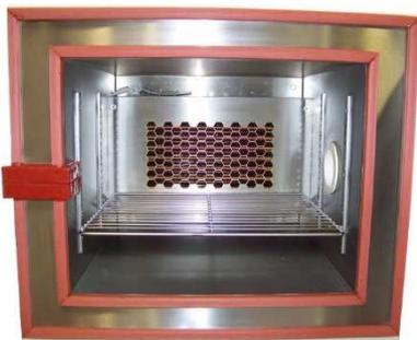
Le **caisson de table TM** est constitué d'une cuve en acier inoxydable et d'une clayette amovible, sur crémaillère, où peuvent être disposés les échantillons.
