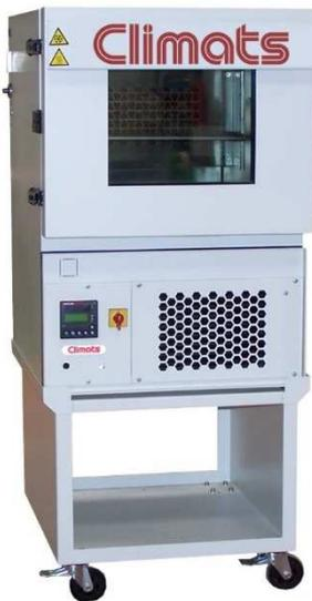
Les **caissons de table** permettent de soumettre un produit à des essais en température de façon à faire apparaître ses éventuels défauts ou à déterminer sa durée de vie.
