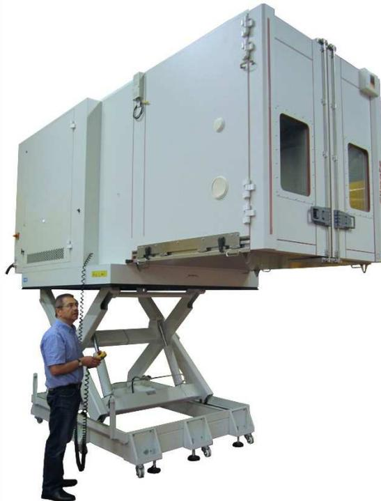
**Mobile sur deux axes et assistée dans ses déplacements verticaux**, cette enceinte chaud - froid - humide permet de tester des produits volumineux en conditions couplées de vibrations et température.
