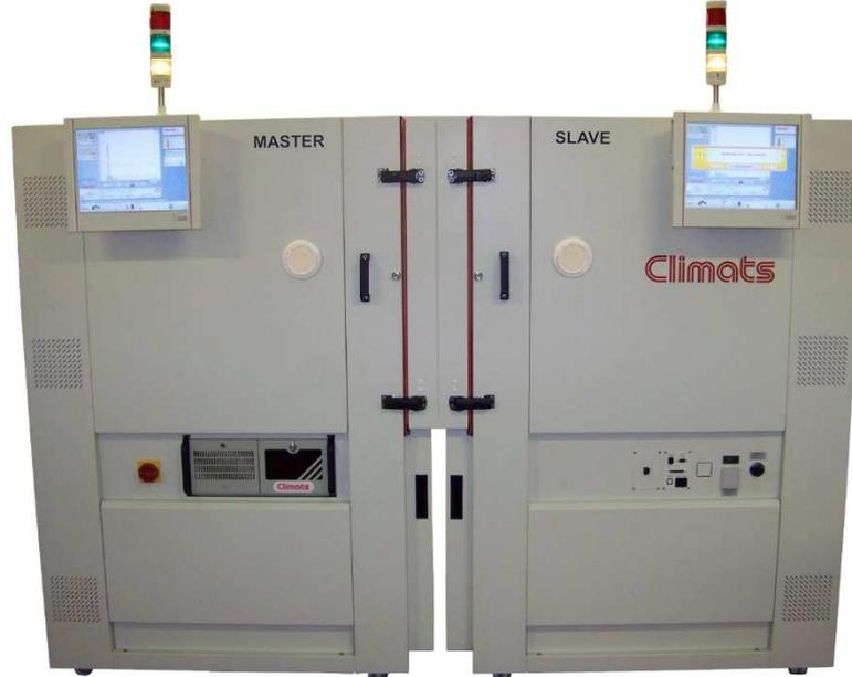
Assemblées mais indépendantes, ces deux enceintes de type Excal 140 "chaud froid humide" permettent de tester des vitrages ou matériaux sous deux conditions climatiques différentes pouvant éventuellement représenter des climats extérieurs et intérieurs.
