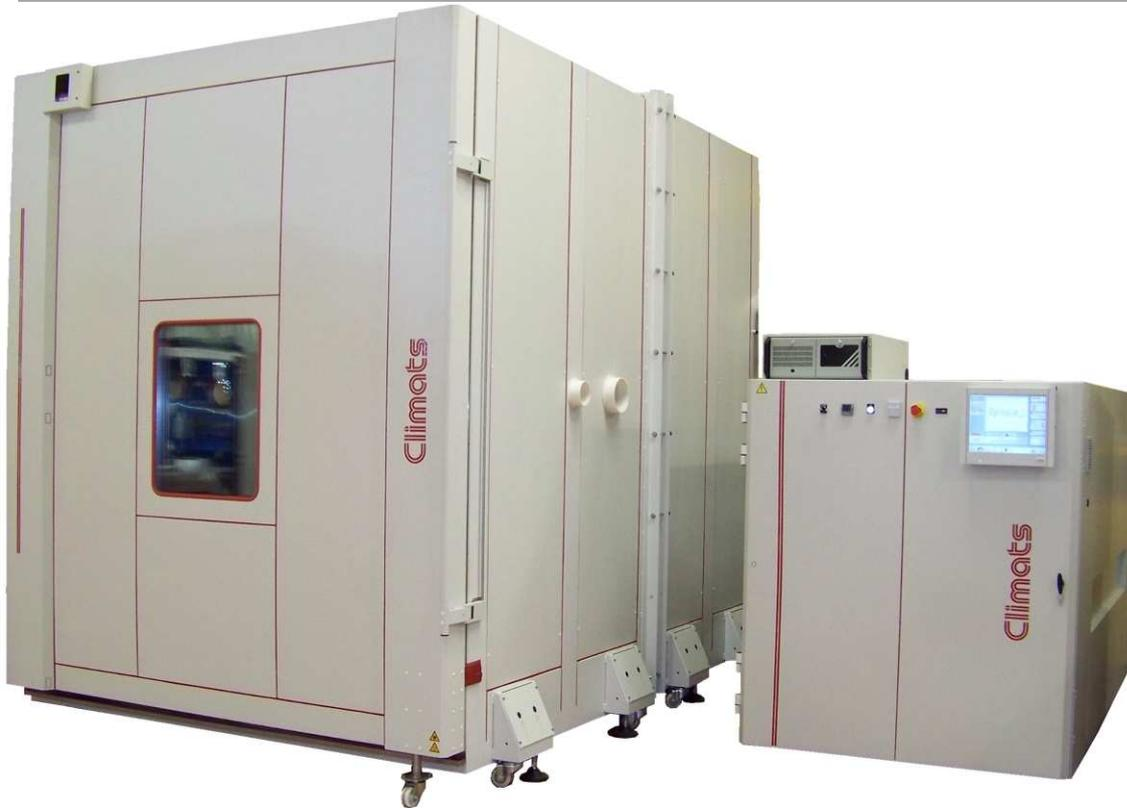
Chambre climatique Chaud-Froid-Humide, d'un volume de 13750 dm<sup>3</sup>, destinée, entre autre, à réaliser les normes :
