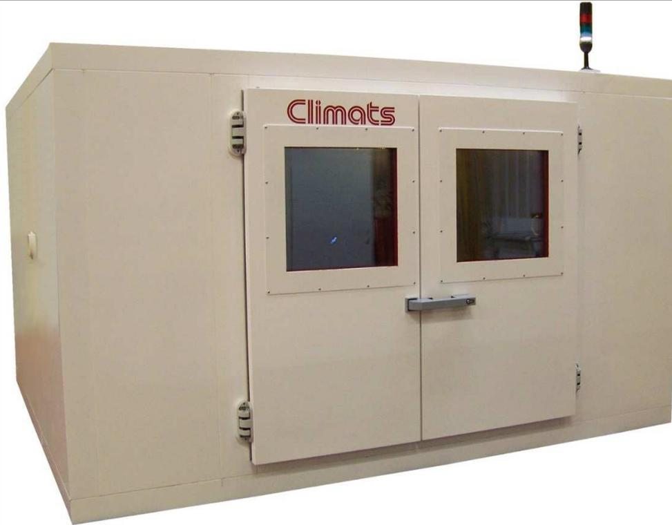
**Chambre modulaire de 9 m<sup>3</sup> destinée au secteur aéronautique** pour tester des produits volumineux lors d'essais stabilisés de plusieurs heures à +60°C puis à -20°C.
