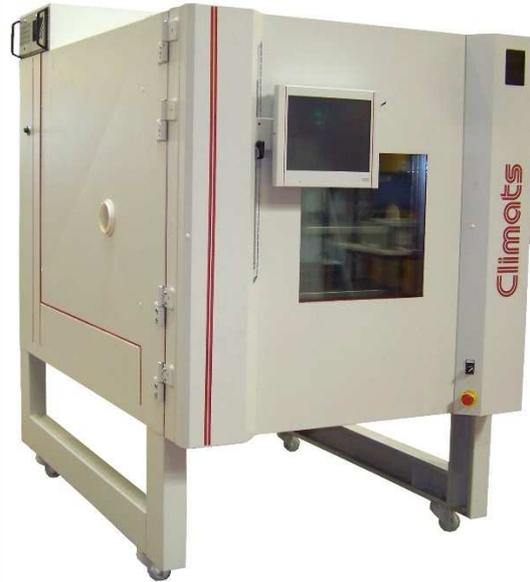
**Enceinte climatique de 1130 dm<sup>3</sup>** conçue pour venir s'encaster autour d'un socle en béton afin de réaliser des essais thermiques avec une parfaite stabilité vibratoire.
