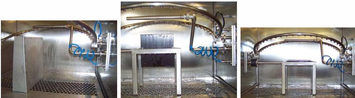
L'eau utilisée pour l'aspersion est recyclée grâce à un bac de rétention. Les remplissages et vidanges sont automatisés.
