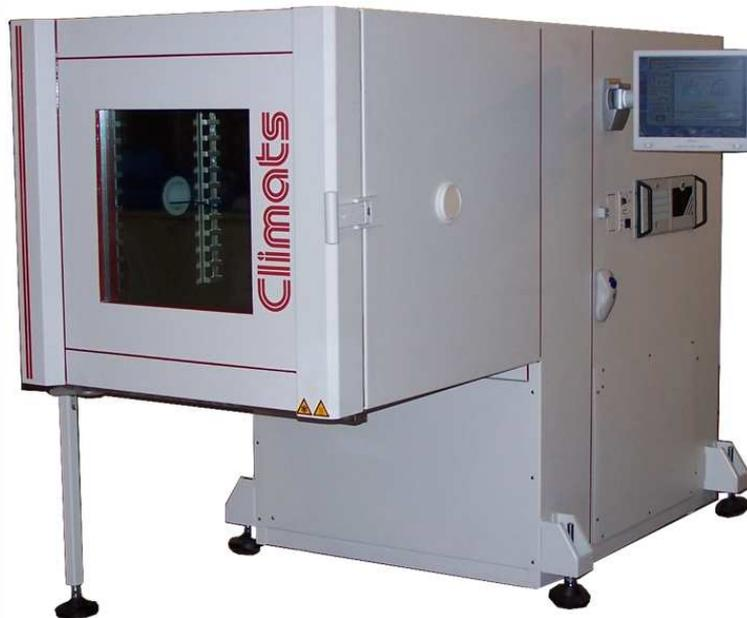
Enceinte climatique de 343 dm<sup>3</sup> adaptable sur pot vibrant, avec accessoires de sole pour une utilisation en enceinte standard.
