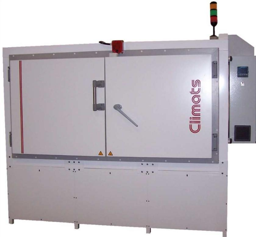
Enceinte thermique de 1350 dm<sup>3</sup> destinée au déverminage de 300 kg de composants en température positive (70/85°C).
