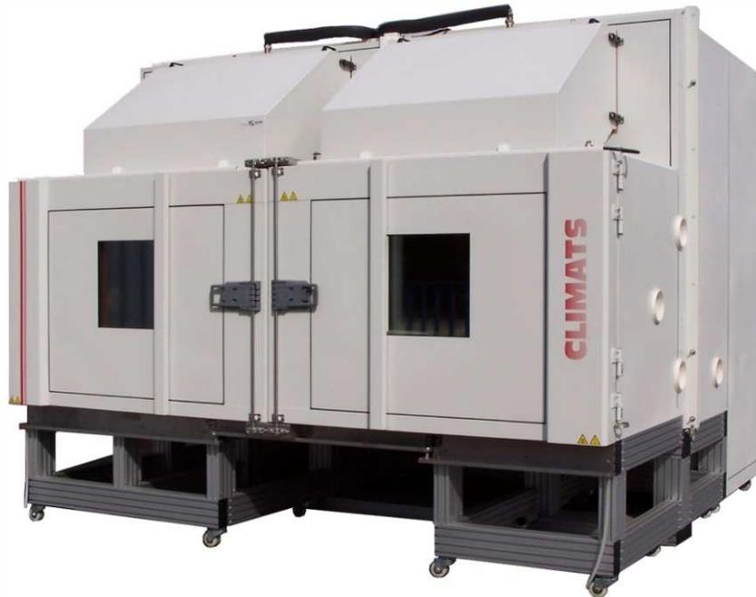
Enceinte climatique de 4000 dm<sup>3</sup> pour essais combinés en vibration et température.
