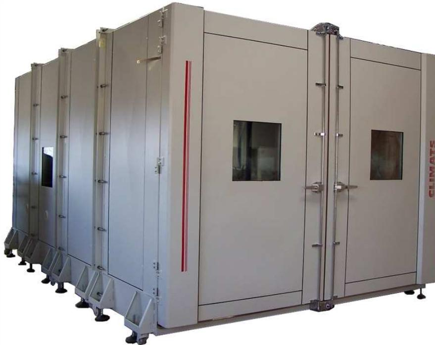
Enceinte climatique de grande capacité (26 m<sup>3</sup>) composée de 4 anneaux.
