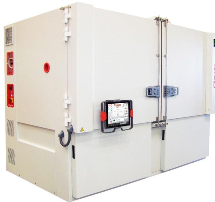
Avec un volume utile de 2000 dm<sup>3</sup>, cette enceinte de vieillissement couvre une plage de température allant de +20°C à +100°C et atteint une vitesse de variation moyenne de l'ordre de 1°C/min entre +20°C à +70°C, avec charge de 50 kg de matériaux composite. La **double porte** permet une excellente ergonomie pour le **chargement de pièces de grandes tailles** à plat.
