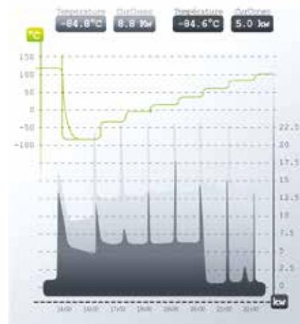
Ce cycle d'essai type démontre parfaitement le gain en énergie d'un cycle "Energy Saving" (la courbe en gris foncé) par rapport à un cycle sans ce mode (courbe en gris clair). Vous disposez d'un affichage instantané des consommations électriques.
