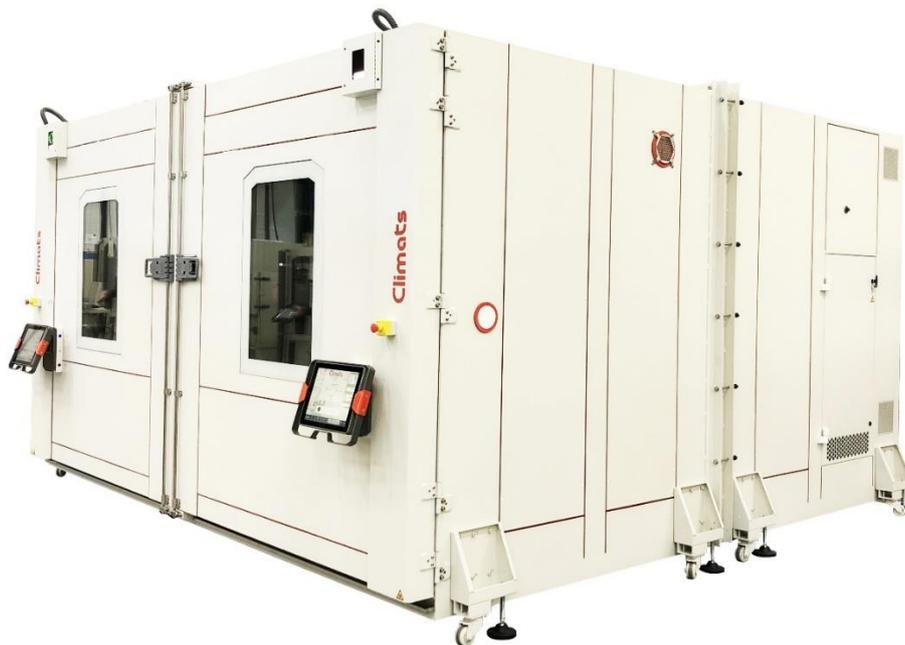
La spécificité de cette enceinte climatique est sa constitution en **deux cuves identiques et indépendantes**, pouvant être réunies pour des essais sur des pièces de grande taille. Chaque cuve est parfaitement indépendante et possède son propre système de pilotage de température et d'humidité relative. La séparation des cuves est réalisée par une cloison amovible, composée de panneaux ergonomiques qu'il est aisé d'installer ou de désinstaller selon la nature de l'essai.
