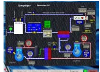
Un synoptique dynamique permet de contrôler les pressions, la circulation des fluides, ... sur votre écran
