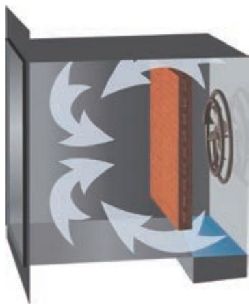
Brassé par un ventilateur haute température, l'air est aspiré et conditionné dans le compartiment technique, puis refoulé dans l'ensemble du volume de test.
