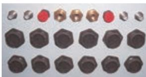
Exemple de réalisation de 9 connecteurs et 12 sondes d'humidité
