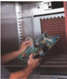
Pour **un positionnement idéal de vos produits dans l'enceinte**, les supports d'étagères sont disposés sur toute la hauteur du volume d'essais. Vous pouvez optimiser vos essais en utilisant plusieurs étagères pour un même essai.
